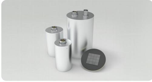
ELBC-D25H25SIPM01能谱探测器是包含1英寸的溴化镧闪烁晶体、硅光电倍增管（SiPM）、求和电路、前置放大电路和温度测量电路的高度集成化探测器,具有能量分辨率好、使用简单、体积小、可靠性高等特点。广泛应用于工业探测、放射医疗和辐射探测等领域。
