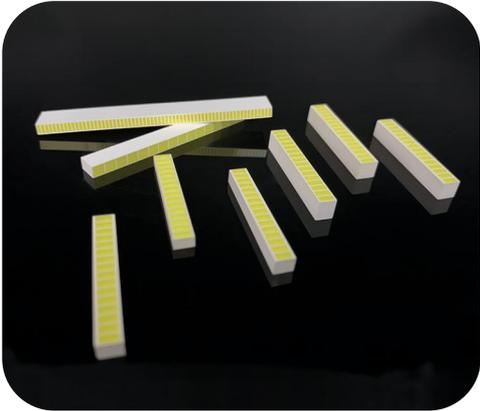
基于闪烁体制作的线性阵列一般用于X射线行李安检、集装箱扫描、工业无损检测等领域。上海烁杰用于制作线性阵列的闪烁体包括碘化铯CsI晶体、钨酸镉CWO晶体、硫氧化钆GOS陶瓷以及GAGG晶体等；可根据用户需求定制阵列中的像素尺寸和数量，常用的反射层材料为二氧化钛TiO<sub>2</sub>，阵列具有高光输出、高灵敏度、优秀的能量分辨率以及阵列像素间、阵列与阵列间可靠一致性等优点。
