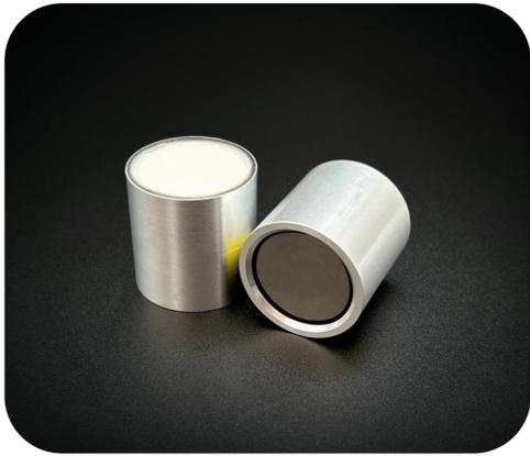
溴化铈晶体(CeBr<sub>3</sub>Crystal)具有出色的闪烁性能,其能量分辨率和衰减时间与溴化镧LaBr<sub>3</sub>相当,同时具有较优的时间分辨特性,可实现对具有不同能量水平的辐射源的准确识别和分析。溴化铈晶体还具有相对较高的有效原子数,并且其组成元素没有天然放射性同位素,在1500-2200 keV能量范围内,自身本底辐射低于0.001c/s/cc。
